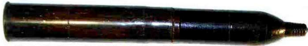
Cartouche française de 75 mm, obus à balles modèle 1897
