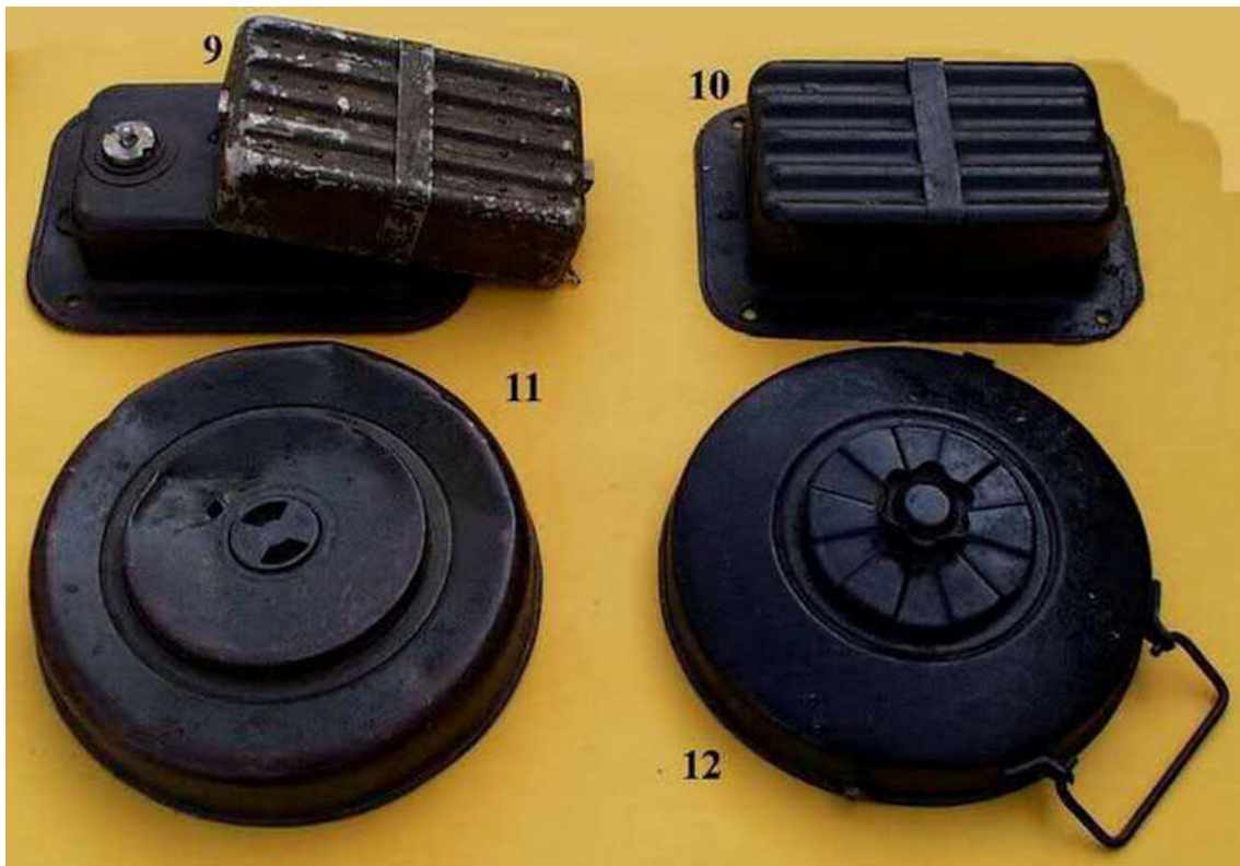
9, 10 : Mines antichars françaises, à gauche avec le couvercle ôté, montrant un des deux allumeurs. A droite, avec le couvercle en place, prête à fonctionner. Ne jamais tenter d'enlever le couvercle ! 11 : Mine antichar américaine M6. Certaines comportaient un très dangereux allumeur chimique. 12 : Mine antichar allemande « Tellermine 42 ». Ne jamais tenter de dévisser le bouchon central !
